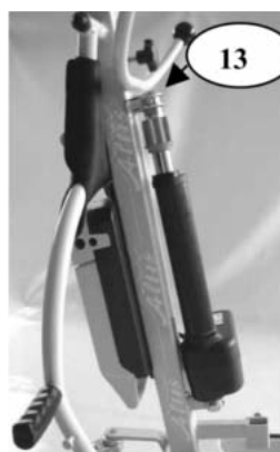
Photo n°8 Tige du vérin goupillé sur le mât en position de transport
